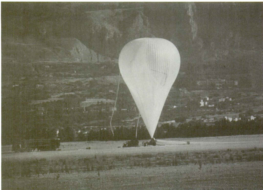
Figura 2. Llançament d'un globus del projecte ILIADA. Aquests globus portaven diferents instruments per a la mesura de paràmetres estratosfèrics. Alguns dels paràmetres mesurats eren la conductivitat i el camp elèctric. Observeu les dimensions del globus comparant-lo amb el camió que es troba a la vora, a l'esquerra.
